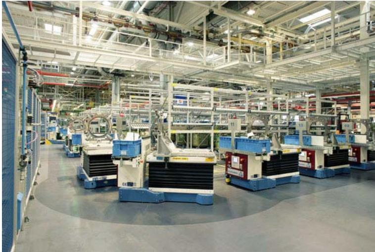
*BU: Bei Daimler in Rastatt sind 35 fahrerlose Transportfahrzeuge versorgt mit IPT® auf einer Strecke von insgesamt 350 Metern bei der Getriebemontage im Einsatz.*
