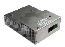
Der Lademanager ist mit einem 24 V Schaltregler ausgestattet, der die angeschlossene Elektronik im Dauerbetrieb mit 6 A versorgt. Wenn sich der Leistungs-Pickup auf dem Leistungsloop befindet, übernimmt er die Energieversorgung der Platine und die Akkus werden aufgeladen. Die Platine misst den Ladestrom und regelt ihn konstant auf 12 A (48V). Die Temperatur des Pickups wird überwacht und Statusmeldungen werden an die Fahrzeugelektronik übertragen.
