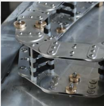
Programm LZ94: rotierende Ketten-Anwendung, konform mit Richtlinie ATEX Zone 2
