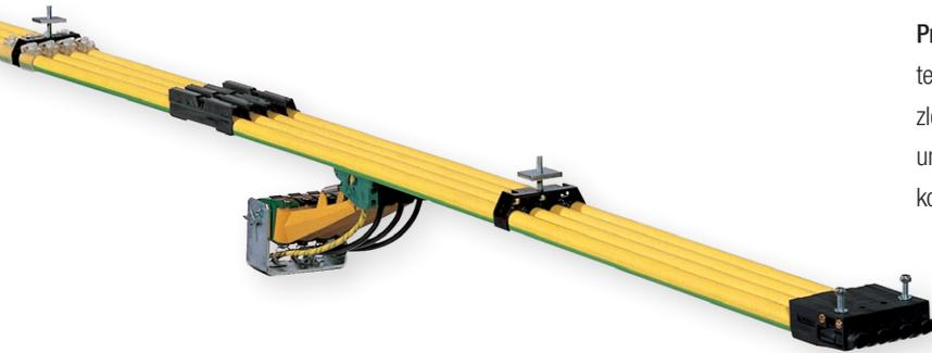
**0811 SingleFlexLine** ist ein Schleifleitungssystem, das typischerweise in Loop- oder Line-Sortern sowie in Gepäckförderanlagen eingesetzt wird. Rein-Graphit-Stromabnehmerkohlen sorgen für optimierte Lebensdauer und minimalen Verschleiß in kontinuierlich arbeitenden Systemen mit hohen Geschwindigkeiten von bis zu 3 m/s.
