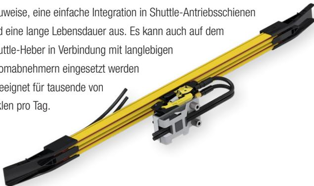
**MultiLine 0831** ist eine kompakte Schleifleitungsschiene für Paletten-Shuttles, die höhere Lasten tragen und mit Wechselstrom betrieben werden. Sie verfügt über eine kompakte 3-, 4- oder 5-polige Isolierung mit vormontierten Verbindern für eine schnelle Montage.
