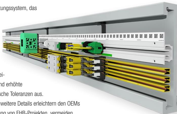
**ProfiDAT® compact** ist ein Schlitzhohlleiter-Datenübertragungssystem für Ethernet-Kommunikation mit optionaler integrierter Schutzleiter- und Barcode-Positionierungsfunktion. Es vereint sichere und geschirmte Ethernet-Kommunikation mit hoher Bandbreite auf dem kompakten Raum eines Aluminium-EHB-Profiles.
