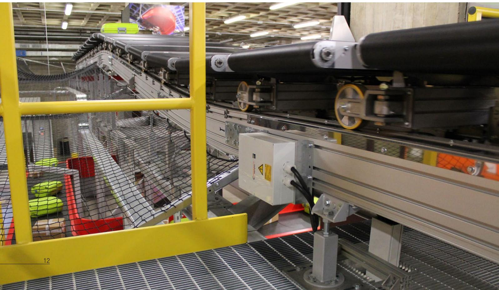
**Quergurt- oder Kippschalensorter** sowohl in der Gepäckfördertechnik als auch in der Paketsortierung müssen extrem zuverlässig sein und sind für einen konstanten Hochgeschwindigkeitsbetrieb von bis zu 3 m/s ausgelegt.
