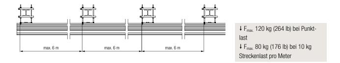
Die Aufhänger sind in der Nähe der Kupplungsstücke zu plazieren (max. 0,4 m entfernt), damit eine optimale Dichtheit zwischen Kupplungen und Schienen garantiert ist.
