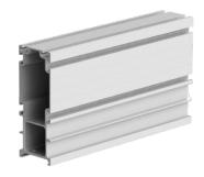
Die Schienen können mit den Kupplungsstücken zu beliebig langen Strängen verbunden werden. Sie sind aus einem geschlossenen Aluminium-Hohlprofil gefertigt und eignen sich für trockene und ölhaltige Druckluft.
