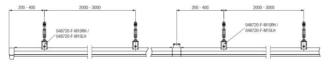
Pro Schienenstrang wird nur ein Festpunktaufhänger (rot) 048720-F-M10RH oder 048720-F-M10LH benötigt. Der Festpunktaufhänger sollte immer nahe der/einer Lufteinspeisung (z.B. Axialeinspeisung 048730-06 oder Einspeiseverbinder 048731-05) befestigt werden.
