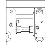
Die Gerätewagen sind auch für größere Lasten bis 80 kg zulässig. Bei Lasten > 20 kg sind jedoch Kriterien wie mögliche dynamische Kräfte zu berücksichtigen und der Aufhängeabstand ist zu überprüfen. Bitte kontaktieren Sie uns bei Rückfragen.
