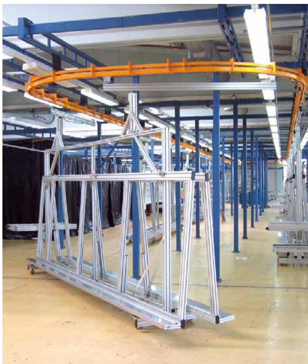
Machine Power & Free pour le montage de jeux de câbles spécifiques au client
