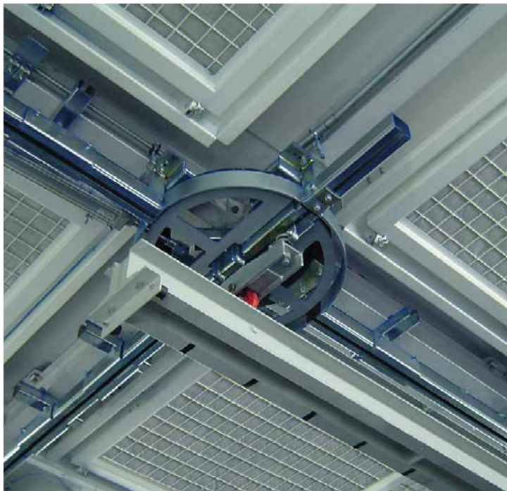
Combinaison d'aiguillages pivotants et d'une grue appareillée avec appareil de levage
