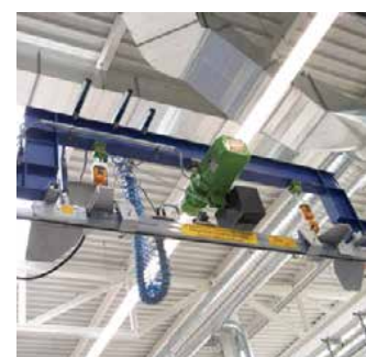
Stations de monte et baisse par une couverture du niveau grâce à un palan à chaîne synchronisé (par exemple bains d'immersion ou suspension ou décrochage de pièces)
