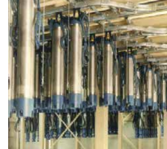
Monorail aérien avec zone-tampon dans une usine de pompes à immersion
