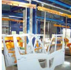
Système à monorail aérien permettant le transport manuel de composants de véhicule
