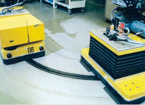
Podlahový transportní systém s indukčním přívodem energie
