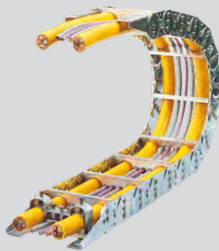
Hliníkový vodicí kanál v šesti stavebních velikostech, s kluzným uložením i bez něho, s variabilní šířkou a jednoduchou montáží, odolný vůči mořské vodě
