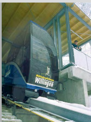
Trolejové vedení napájí kabinu pro přepravu osob na můstku pro skoky na lyžích
