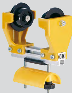
Kabelový vozík s pojezdem po čtyřhranném profilu různá provedení, nosnost do 36 kg, pro přímé, kruhové a zakřivené dráhy
