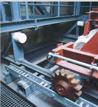
Koncový doraz na jeřábovém zařízení
