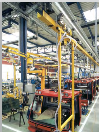
Přívod médií pomocí W 4 -airsolution při výrobě užitkových vozidel
