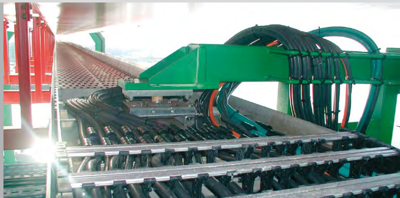
Energetický řetěz s dlouhou dráhou pojezdu na kontejnerovém jeřábu Ship-to-Shore
