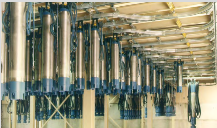
Ruční podvěsná dráha s výhybkami umístěná ve skladu
