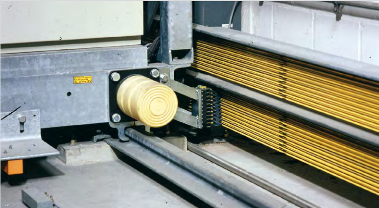
Nárazník na přesuvně v pivovaru
