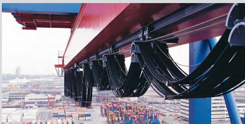
Kabelové vozíky s vlastním pohonem na kontejnerovém jeřábu Ship-to-Shore
