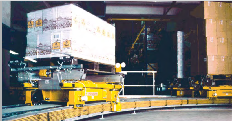
Přesuvny pro mezioperační dopravu potravin - přenos dat realizován pomocí Powertrans® Ib
