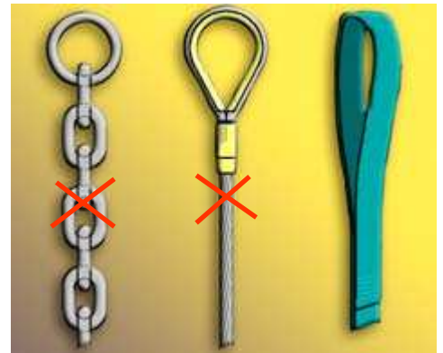
LEVAGE DES DEMI-BOBINES HANDLING OF THE SPOOL HALVES
