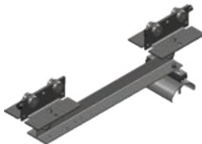
Dos carros y una silla de aluminio de 102mm (4") de diámetro para cable plano, montados en una abrazadera de acero galvanizado o inoxidable de 559mm (22") de largo. Incluye accesorios para sujetar la caja de control. La caja de control se vende por separado, ver pág. 28.
