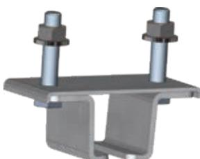
Esta abrazadera se monta a un ángulo de hierro suministrado por el cliente en dos puntos para colgar el Carril en C. Las abrazaderas en "Z" independientes permiten montar la Canaleta del Carril en C sin necesidad de introducirla a través de los sujetadores desde el extremo. La acción de apriete de la abrazadera de soporte elimina la necesidad de un anclaje independiente.
