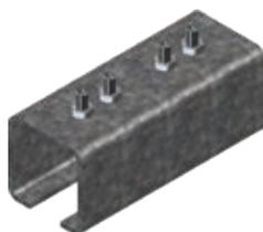
El Empalme para Carril galvanizado emperna de manera segura los perfiles de carril uniendo un extremo con otro. Se requiere uno para unir cada empalme de carril. Incluye 4 pernos, arandelas y tuercas.
