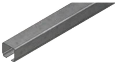
Las Canaletas de Soporte Transversal se montan en forma perpendicular a la viga en I o a la viga maestra cada 1.52 metros para soportar la canaleta del carril en C principal. Puede ver las opciones de montaje en la página 11. Hechas de canaletas resistentes para mayor rigidez.
